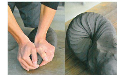
La terre est pétrie et les bulles d' air restantes dans le pain de terre sont chassées par une technique appelée «kikuneri» (malaxage en forme de fleur de chrysanthème).
